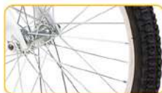
Rodas raiadas com aros em alumínio
