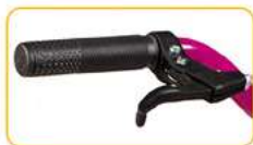
Freios v-brake em nylon com manetes anatômicos
