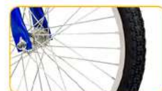
Rodas raiadas com aros em alumínio
