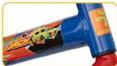
Quadro e garfo em aço carbono
