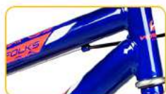
Quadro e garfo em aço carbono
