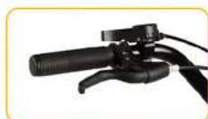
Freios v-brake em nylon com manetes anatômicos
